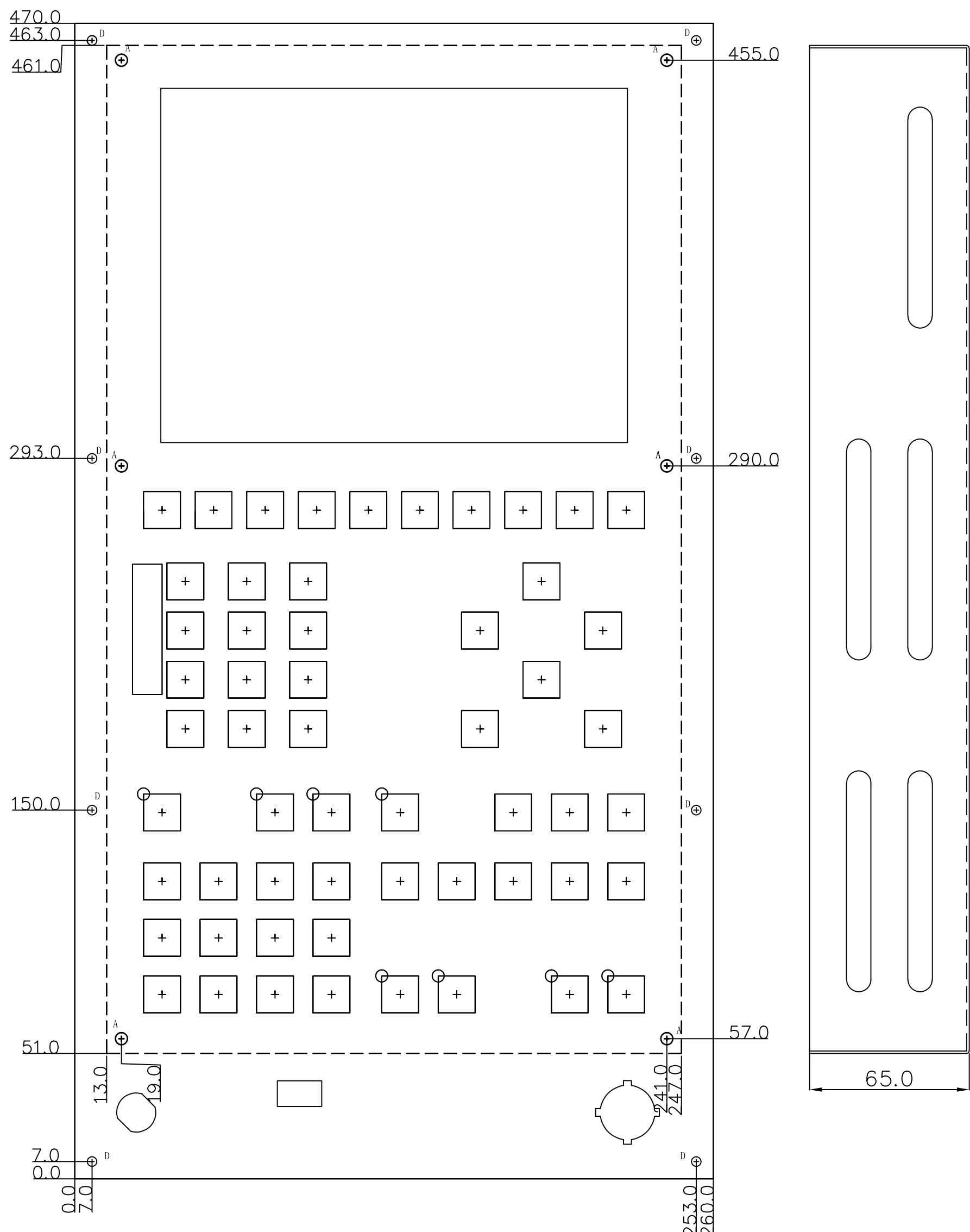
注：图中虚线尺寸为后盖钣金的安装尺寸图
