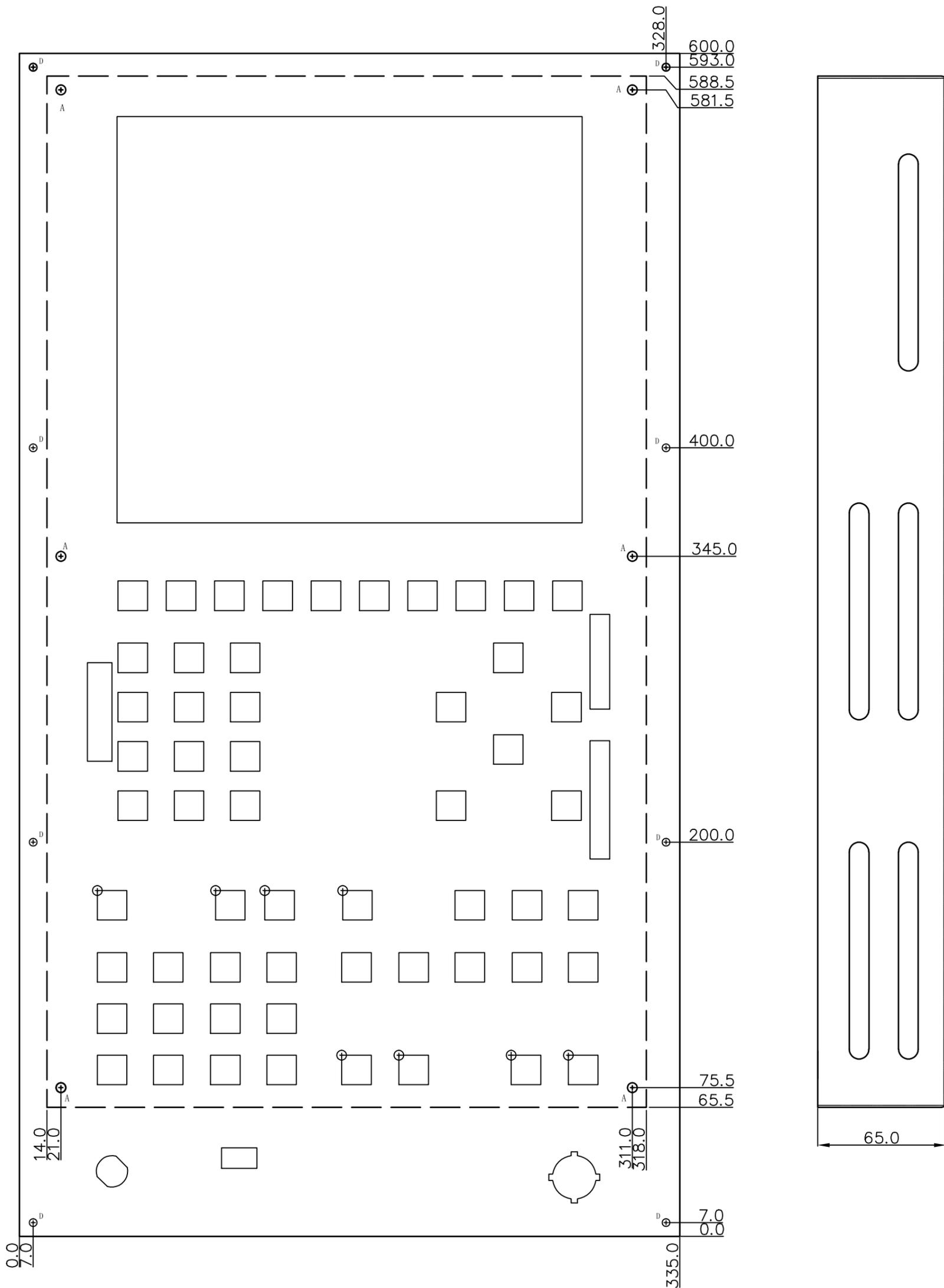
注：图中虚线尺寸为后盖钣金安装尺寸图
