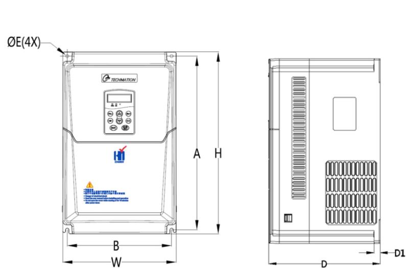
380V 11~37 kW 安装尺寸图
