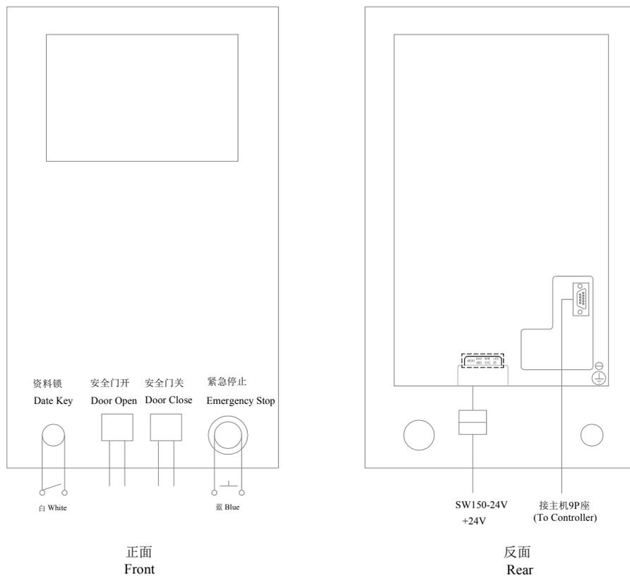
注：图中虚线框中钢印，TM 2647面板后盖钣金无，TM 3355后盖钣金有
