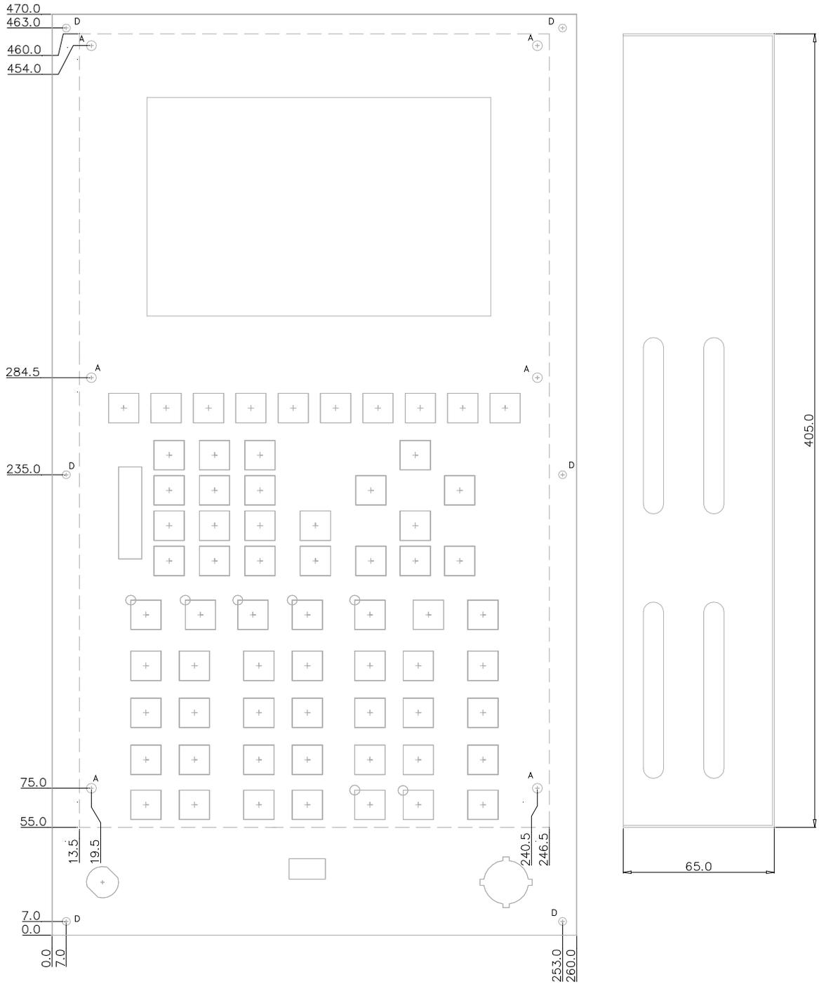
注：图中虚线尺寸为面板后盖的位置尺寸
