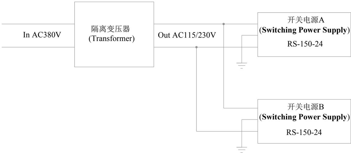
开关电源的 FG 或
