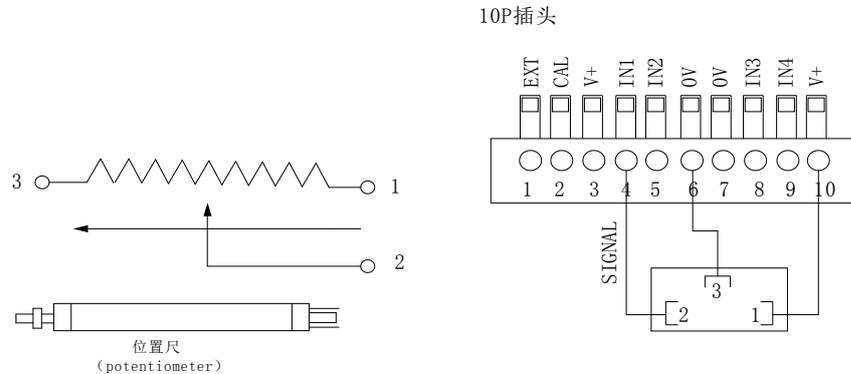
在主机板位置尺输入端子接线脚位如图所示,主机板位置尺的10P插头,第4,5,8,9脚为信号输入脚须接位置尺的信号输出脚。一般而言,位置尺伸长为最大值缩回为最小值,如方向相反,可将位置尺插头3,6脚对换即可,即正负(+,-)极对换就可改变方向,切记信号脚(Signal)不可插错,否则可能导致PCB板或电子尺烧毁。10P插头上的第1,2脚EXT、CAL,此两脚为备用电源输出DC15V,可供客户额外使用需求。
