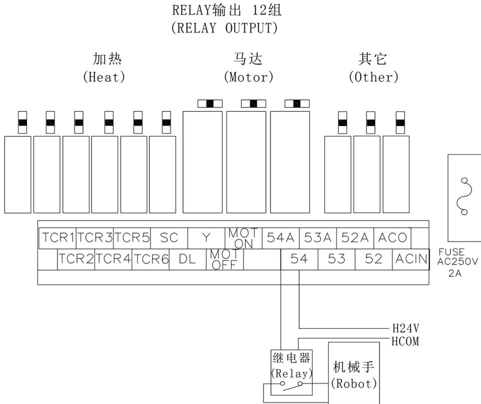
TECHHYBH 电控系统使用继电器输出控制普通机械手，以其中一组继电器输出为例，如上图所示。当电控系统输出机械手动作信号，相应一组常开继电器点 54A 和 54 导通，控制机械手做出动作。
