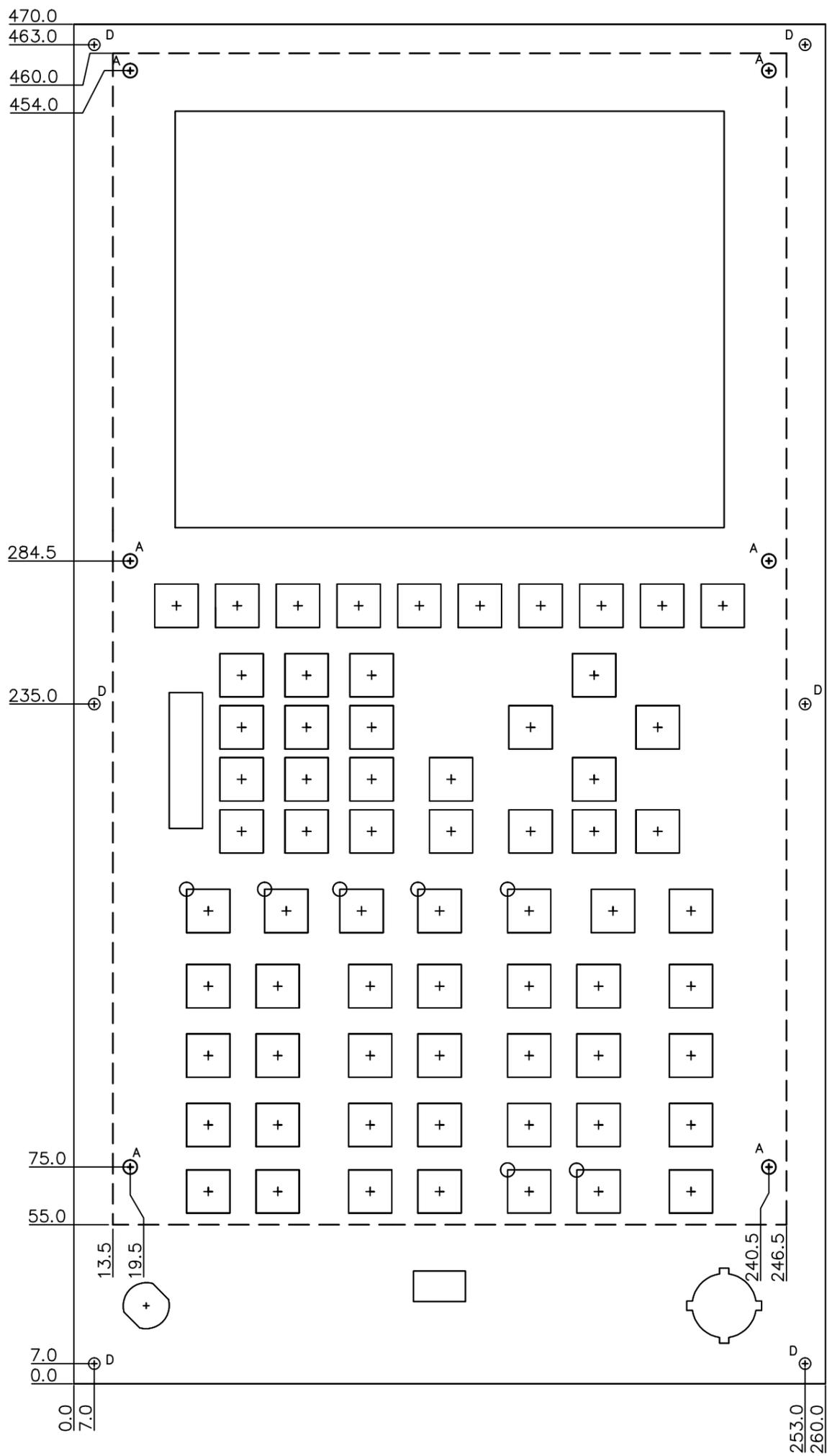
注：图中虚线加粗尺寸为后盖钣金安装尺寸图
